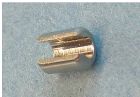
Mini-tube fendu à sertir à la place du ressort écrasé.
